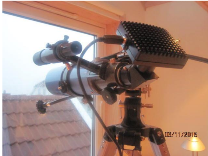
Meade DSI III kameraet i "horisontal stilling" koplet til SkyWatch
