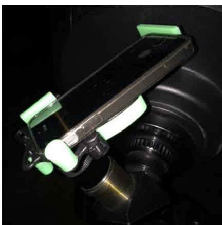
Mobiltelefonen stabil posisjon koplet til Metochi teleskopet
